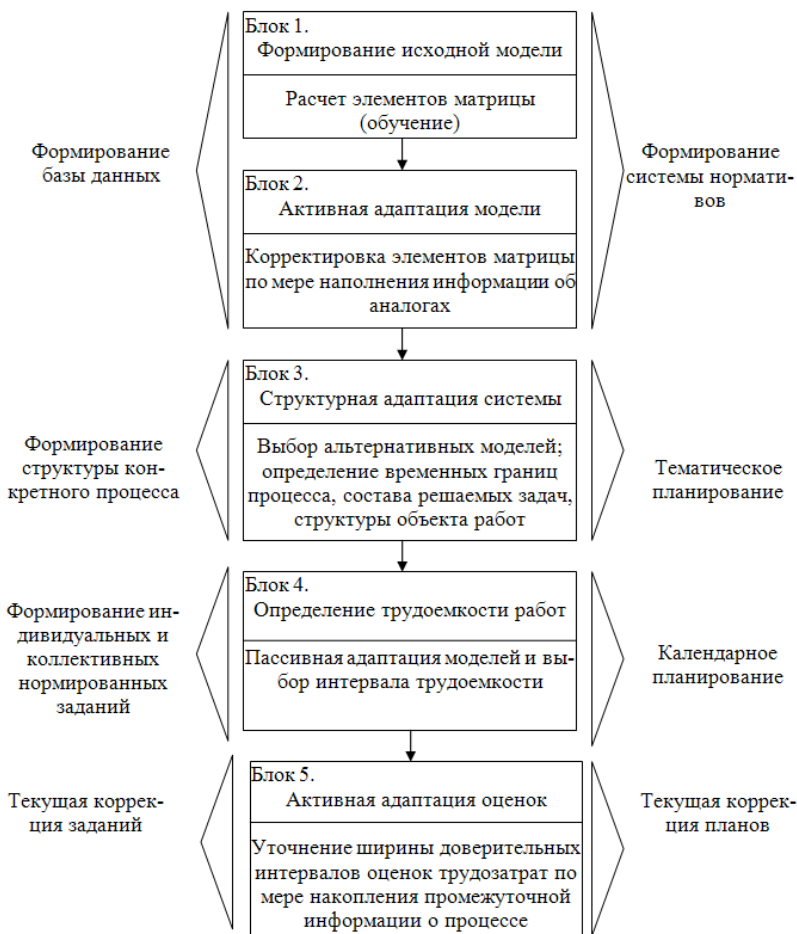
Рис. 1.3.1. Схема процесса определения трудоемкости работ
