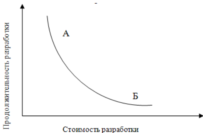
Рис. 1.2.1 Функциональная зависимость «продолжительность — стоимость» [29].
